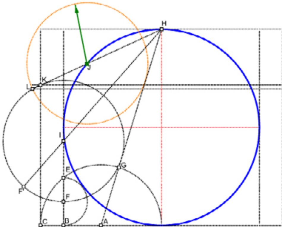
Fig 6 . Tous les arcs et les angles obtenus par tracé géométrique donnent les différentes hauteurs et longueurs des éléments composants l'édifice, comme on peut le voir avec un dessin d'une coupe longitudinal du panthéon.
