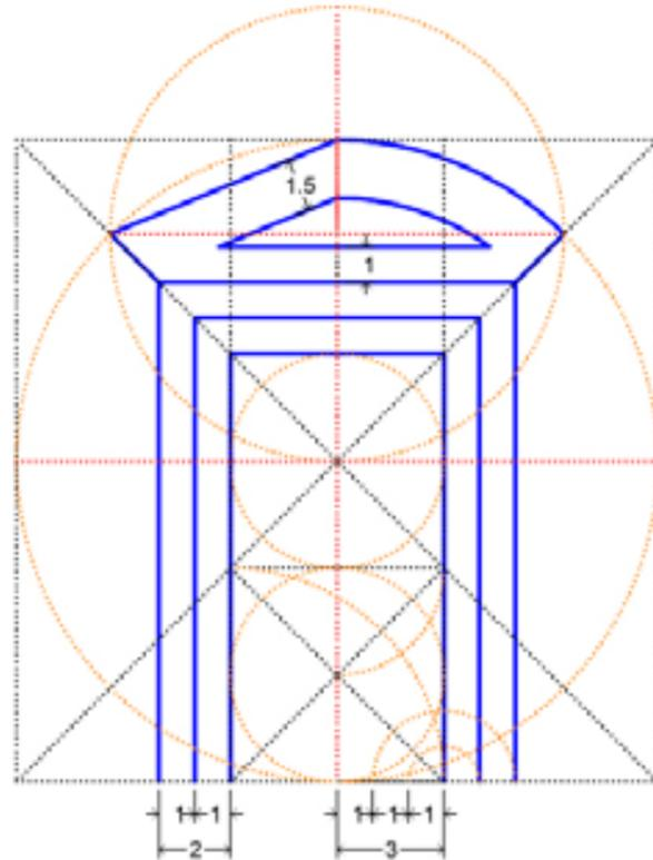
Fig 2-5 Les proportions données sont celles pour créer une grande ouverture avec un fronton angulaire ou curviligne.
