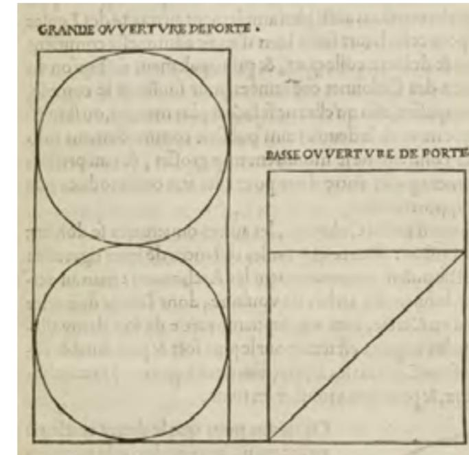
Fig 1-2 Description des tracés proportionnels à donner à une grande ouverture et à une ouverture moyenne.
