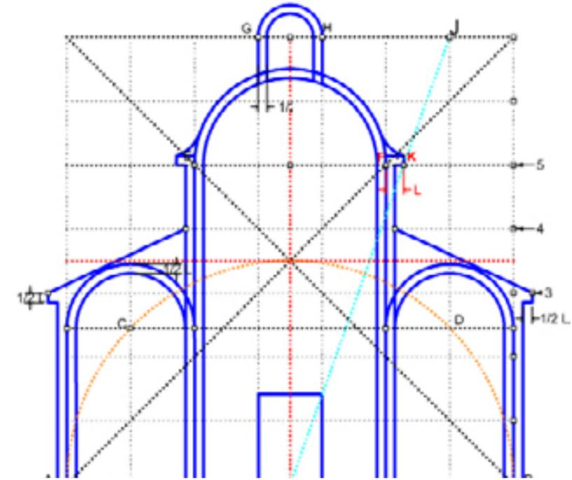
Fig3-5 Coupe obtenu à partir d'une ouverture réalisé en moyenne et extrême raison donc au nombre d'or.
