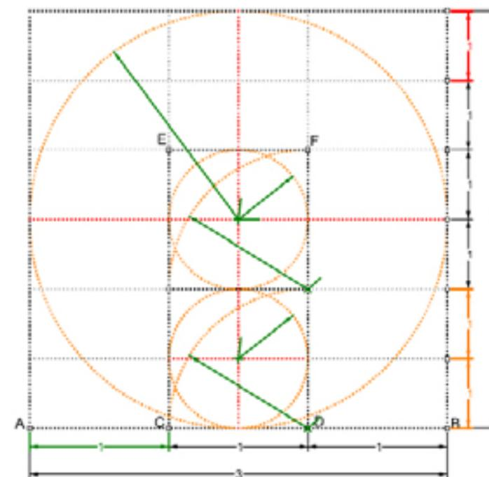
Fig 1-2 Diviser la 6 divisions sur la hauteur en 3 parties, ce qui vous donnera la hauteur de la corniche, de la frise et de l'entablement. Puis tracer la grande porte centrale avec le plein cintre.
