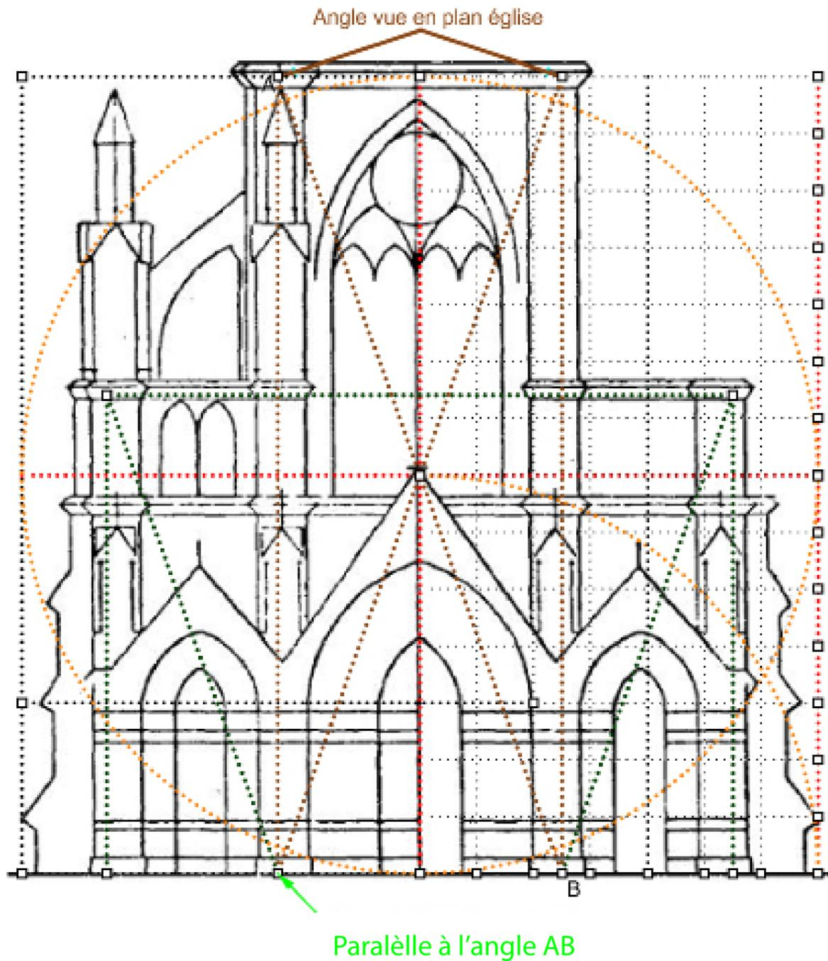
Fig 14-3 Le triangle équilatéral donne le centre de l'oculus du fenestrage et l'ogive de la porte centrale, qui a pour proportion 8/5. Ces deux triangles sont des triangles proportionnels (aperçu dans la partie les triangles de proportion).
