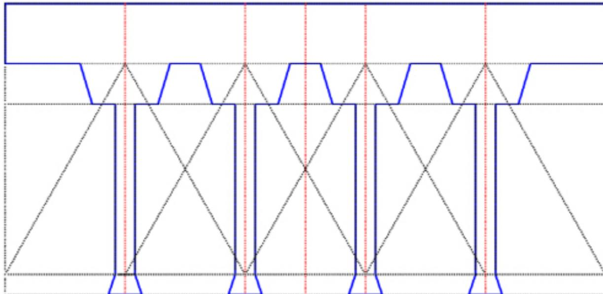
Nous allons réaliser la coupe de la coupole de ce palais à partir de la coudée comme rapport de mesure et du triangle 3-4-5 comme rapport géométrique. On commence par tracer la longueur qui est de 8 coudées.
