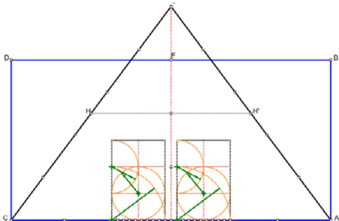
Fig 3 Puis tracer le reste avec les dimensions données, les jambages, la hauteur et la saillie du bandeau, le fronton.
