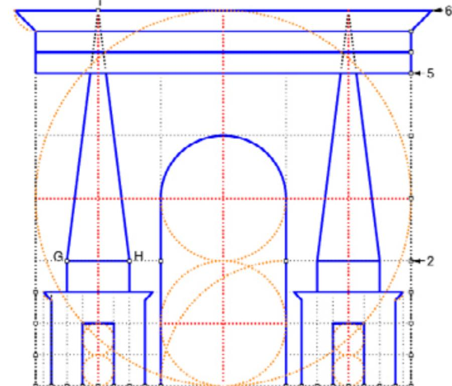
Fig 1-5 Pour une porte réalisée au 18ème, on sent encore l'inspiration de la renaissance avec des rapports simples avec des principes de la méthode graphique.
