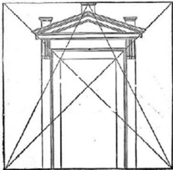
Fig 2 Tracer une longueur AB correspondant à 3 fois la portée de votre porte, puis effectuer les tracés géométriques représentés avec les mêmes proportions. Le carré donne la hauteur de la porte avec le fronton.
