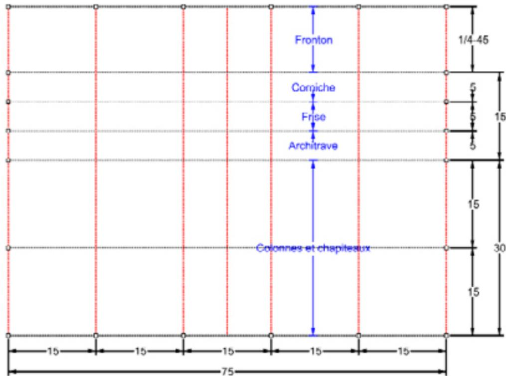
Fig 3 Dans le style dorique, il est d'usage de modifier les entre-axes des colonnes.
