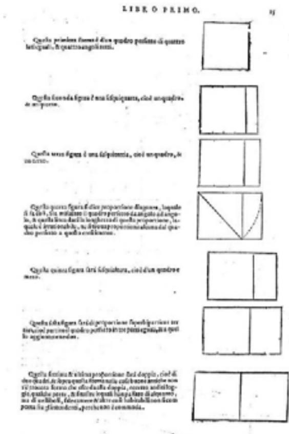
Dans ses carrés, on retrouve ce qu'on vient de voir dans les différentes formes géométriques pour tracer une ouverture moyenne ou de façon à se servir des divisions du carré en prenant les 2/3 de ce carré.
