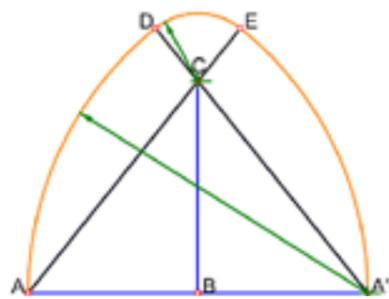
Fig 5 Prendre un triangle 4-5 et se servir du côté de 5 comme base.
