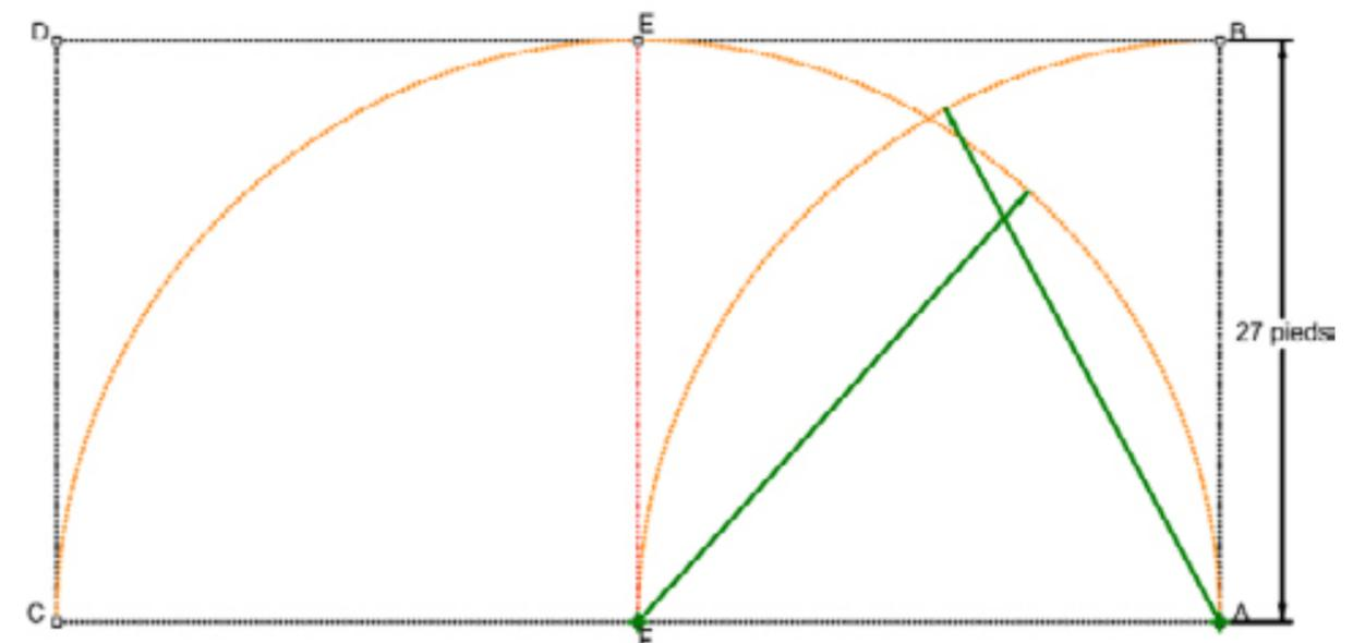
Fig 2 Diviser CA en 6 parties, puis tracer un triangle 3-4-5 en symétrie, cela donnera la hauteur totale. Pour avoir la hauteur du bandeau, il faut diviser DC en trois parties et prendre 2/3 de DC. L'intersection HH' donne la longueur du bandeau.
