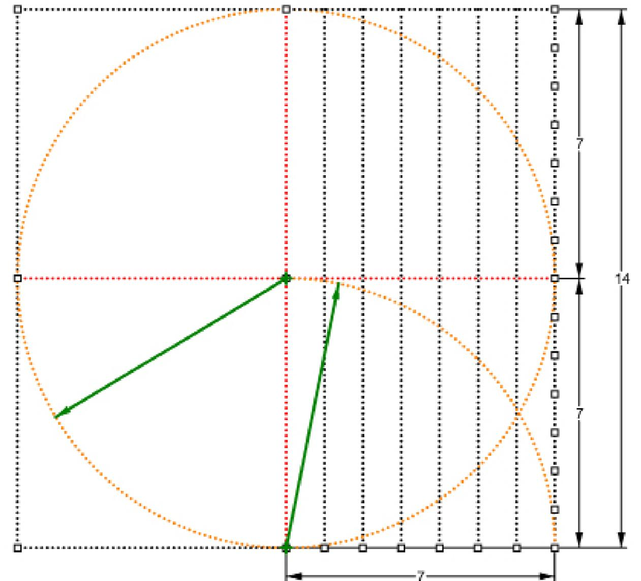
Fig 14-2 Avec une illustration et les tracés représentés, on peut se rendre compte que l'angle AB est le même que celui dessiné dans la réalisation proportionnelle de la vue en plan de l'église.
