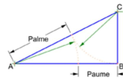
Fig 4] De C faite pivoter à nouveau ABC pour obtenir le pied.
