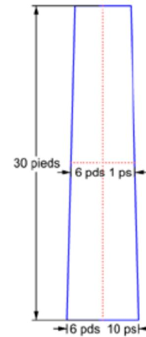
Fig 6 Colonnes centrales avec les dimensions du chapiteau.
