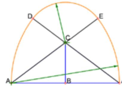
Fig 5 Prendre un triangle 3-4-5 et se servir du côté de 3 comme base.
