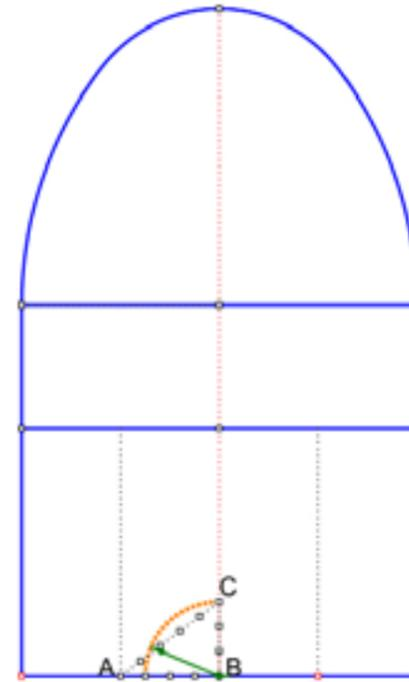
Fig8 Tracer l'arc avec la méthode du triangle 3-4-5.
