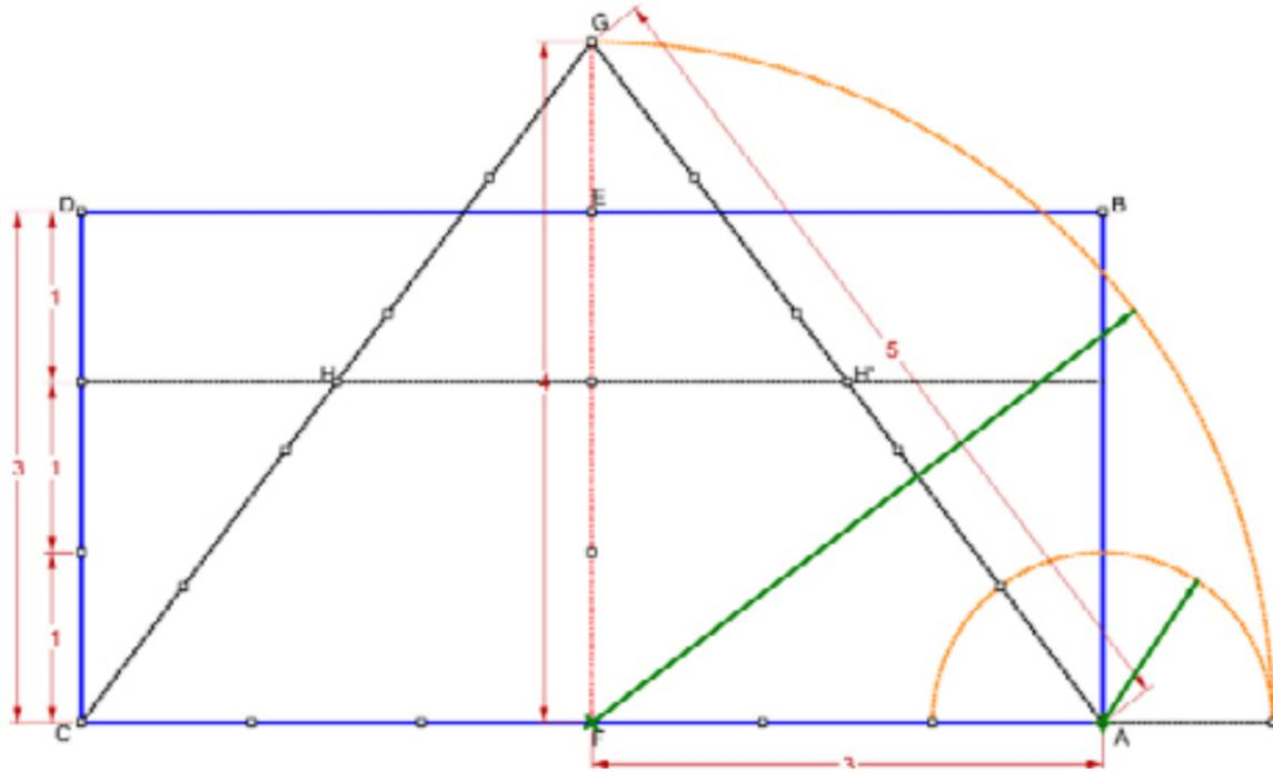
Fig 3 Ensuite à partir de l'axe tracer 1 pied en symétrie, puis prendre 1/6 d'AC qui est de 9 pieds pour avoir la portée des baies. Pour obtenir la hauteur des ouvertures, tracer une fois et demie la portée.
