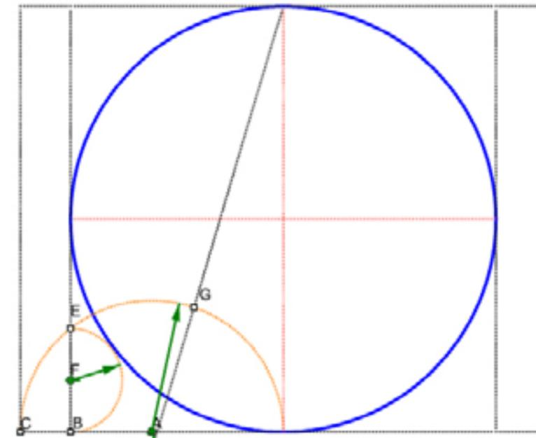
Fig 5 De F prendre la distance du rayon AC pour obtenir le cercle IF', qui sera tangent à la droite AH. Une fois le point F obtenu, tracer le segment HF'.
