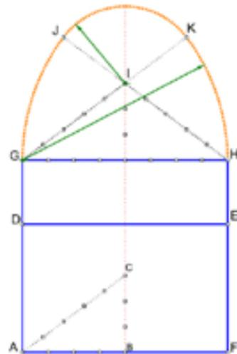
Fig5 la coupe de ce monument a été réalisé à partir triangle 3-4-5, avec ses différentes Hauteurs et la coupole.
