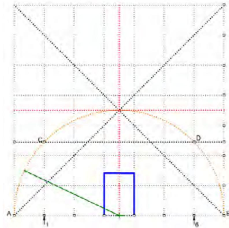
Fig3-3 Tracer les deux premiers plein cintres avec les centres C et D. A partir de l'axe tracer le plein cintre de diamètre EF à la hauteur de la 5 divisions, et celui de diamètre GH à la 7 divisions.
