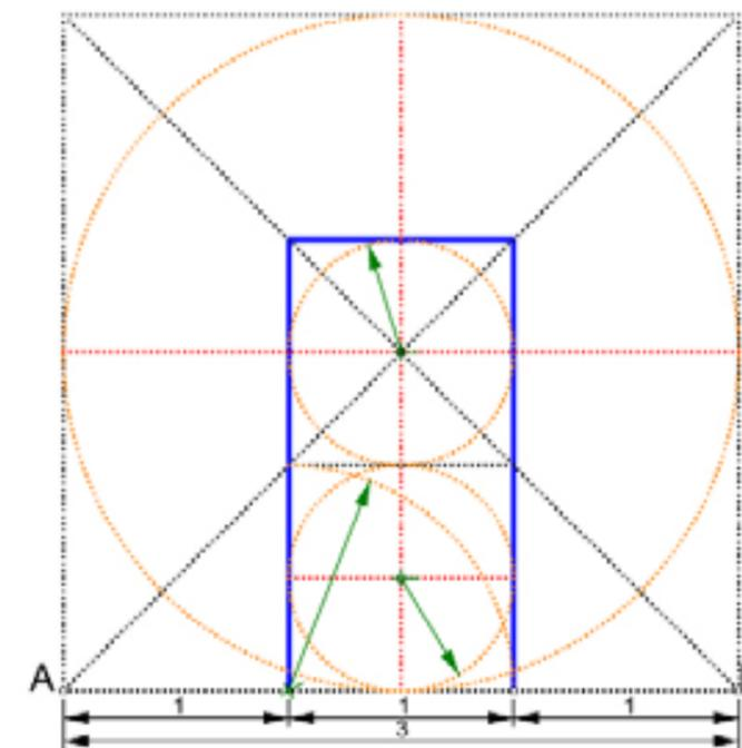
Fig 2-3 Tracer le segment CD à partir de l'intersection du cercle avec les diagonales du carré, une fois ce tracé effectué, vous avez les proportions du fronton. Vous pouvez réaliser un fronton angulaire ou curviligne, en reliant CE ou en traçant la courbe à partir du centre du deuxième cercle de l'ouverture.
