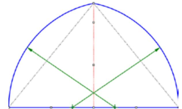
Fig 3 Une ogive en lancette tracée à partir du triangle isocèle rectangle.
