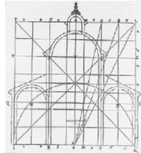
Fig 3 Tracé un carré ayant pour proportion 7 de côté en prenant comme base d'unité la portée de l'ouverture moyenne, puis quadriller le carré en 7 divisions .
