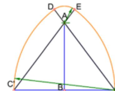
Fig 2 Tracer la symétrie du triangle ABC en A'BC, puis prolonger les droites AC et A'C.
