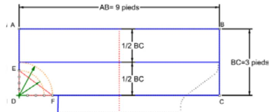
Fig 9 Prendre La distance d et la reporter 3 fois sur la hauteur. De 2d tracer une droite qui servira à tracer la partie concave du talon du chapiteau, elle sera tangente à l'angle du triangle 3-4-5 et à l'angle de la colonne.
