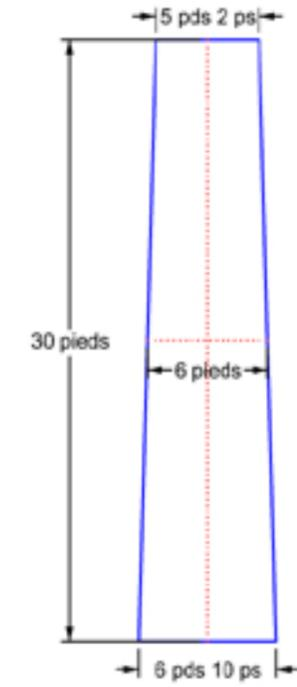
Fig 7 Colonnes des bas cotés avec les dimensions du chapiteau.
