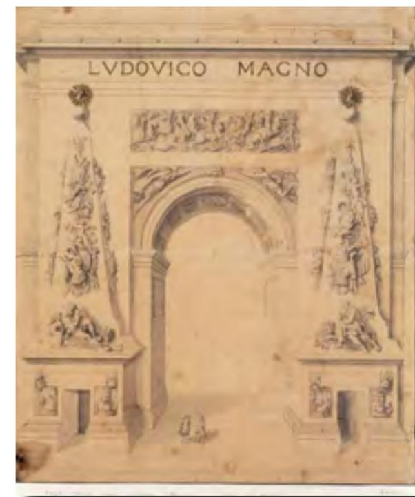
Fig 1 Tracer un carré de 3 de coté, puis diviser sa hauteur en 6 parties, ensuite tracer la grande ouverture EFDC en prenant comme portée une division (1), et 4 pour la hauteur. Tracer ses formes géométriques en vous aidant des cercles.
