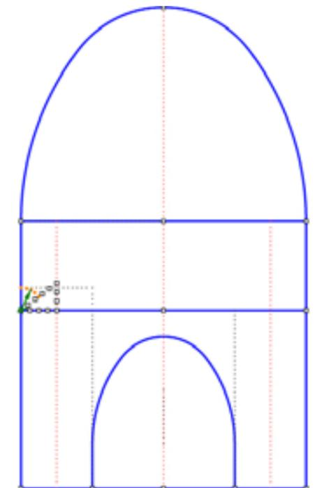
Fig 10 Tracer l'arc avec la méthode du triangle 3-4-5, et reproduire cette arc en symétrie à partir de l'axe.
