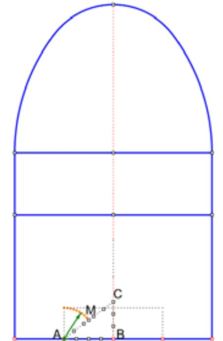
Fig 9 Diviser le quart de la longueur par deux puis reproduire la méthode de la Fig 7 sur la deuxième partie de la hauteur.
