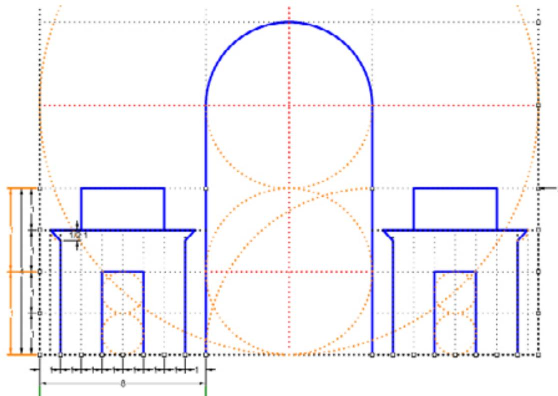
Fig 1-4 Pour tracer les obélisques il faut partir de la 2 divisions jusqu'à la 6 sur la hauteur en effectuant le triangle IGH en symétrie, puis arrêter l'obélisque à la 5 divisions sur la hauteur.
