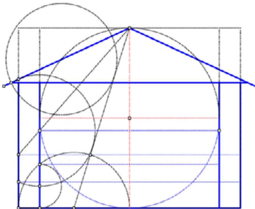
Les proportions de cette maison en pierre pourraient être utilisées dans le sud, avec une inclinaison de toit dans la norme demandée, et à partir de ce module l'ensemble de la maison peut être réalisé.
