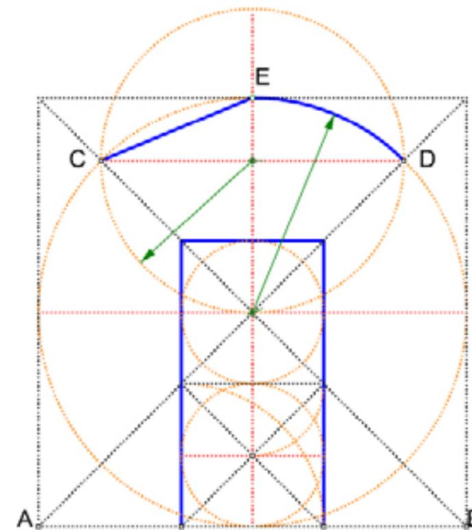
Fig 2-4 Diviser la demi-portée en trois parties, puis prendre deux divisions pour la largeur des jambages. Ensuite pour les moulures du fronton, prendre 1 pour la moulure au dessus de la porte et 1.5 pour celle du fronton.
