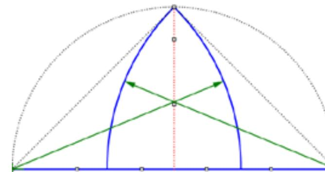
Fig 4 Une ogive tracée à partir triangle isocèle égyptien.
