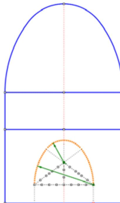
Fig 7 De A tracer reporter la moitié de l'hypoténuse qui donnera la ligne de naissance et la hauteur des jambages de l'ouverture.
