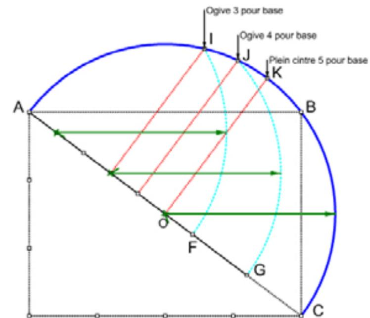
Fig 10-3 Une fois les ogives tracées sur l'hypoténuse ayant pour proportion 5, rabattre les deux ogives sur les cotés du rectangle avec pour proportion 4 de longueur et 3 de hauteur. Cet exercice peut être réalisé de la même manière avec un rectangle barlong de 8/15 de proportion.
