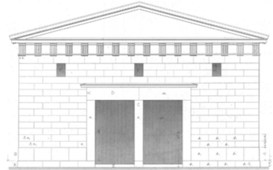
Fig 1 La hauteur de la façade sans le fronton mesure 27 pieds, tracer une double carré en ABCD qui donnera la longueur.
