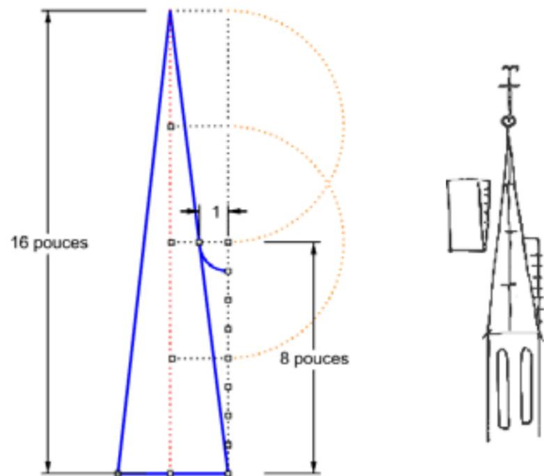
Fig 10 Tracé d'une travée de voûte d'ogive à partir du triangle égyptien 3-4-5 et d'une spirale.
