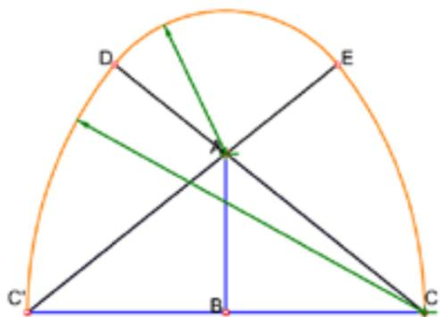
Fig 2 Tracer la symétrie du triangle ABC en A'BC, puis prolonger les droites AC et A'C.
